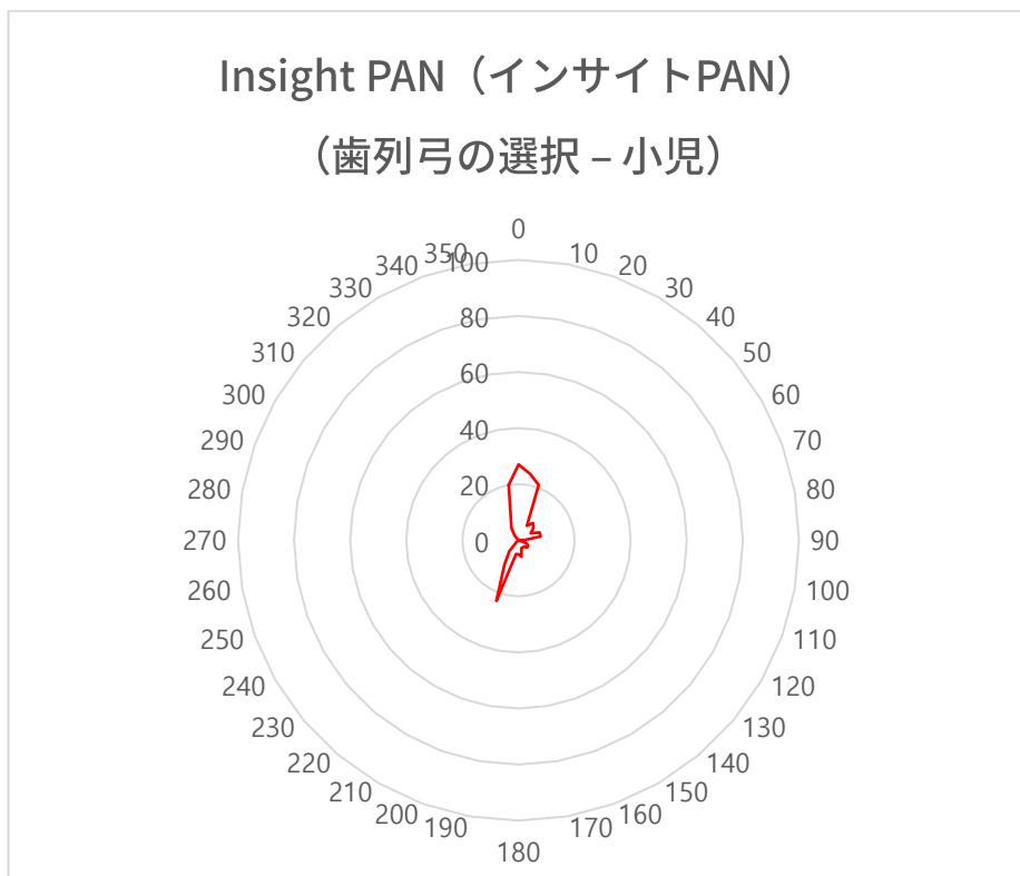
PANO (Insight PAN, Child) (インサイトPAN、小児) の漏れ線量試験グラフ
