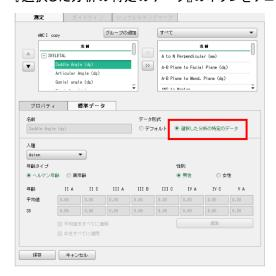
5. 分析項目のチェックボックスは、ユーザーが選択/選択解除することができます。チェックボックスで選択された項目のみ、分析方法を選択する際に、分析タブ及びシミュレーションタブに表示されます。
